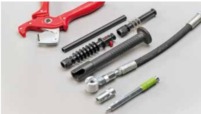
v.l.n.r.: Ablängschere, Gelpacker, Einschlaghilfe, Schiebekupplung mit Drehgelenk und Injektionspeitsche 250 mm, Greifkopf, Packer mit Kegelkopfnippel
