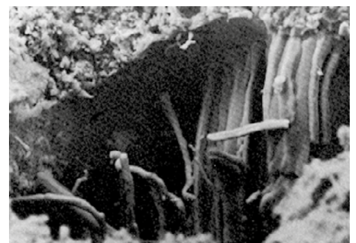
Die Kristallisation der Salze in den Poren des KÖSTER Sanierputzes verhindert Salzausblühungen und Schädigungen.
